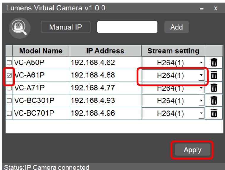
4.2.5 連接成功後將顯示"IP Camera connected"，並同時顯示解析度資訊。
